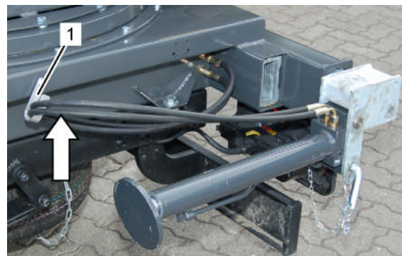
Afb. 63: Hydraulische leidingen controleren
