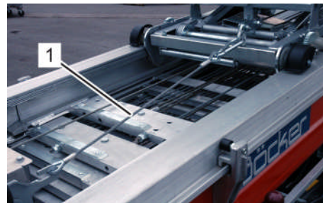
Fig. 138: Câble de sécurisation
