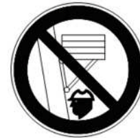
Fig. 2: Ne pas se tenir sous la charge
