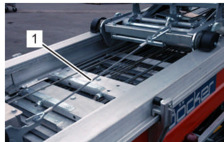
Fig. 261: Câble de sécurisation
