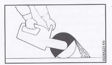
Ajuster correctement le capot protecteur qui recouvre le disque : de telle sorte que les particules de l'objet à découper soient déviées dans le sens opposé à l'utilisateur et à la machine.
