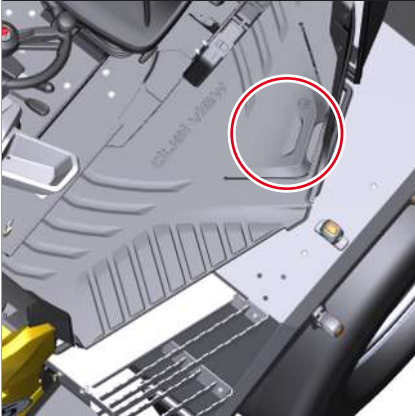
Fig. 211: Réservoir d'eau de lavage
