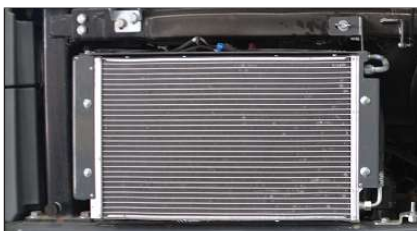
Fig. 227: Condenseur de climatisation
