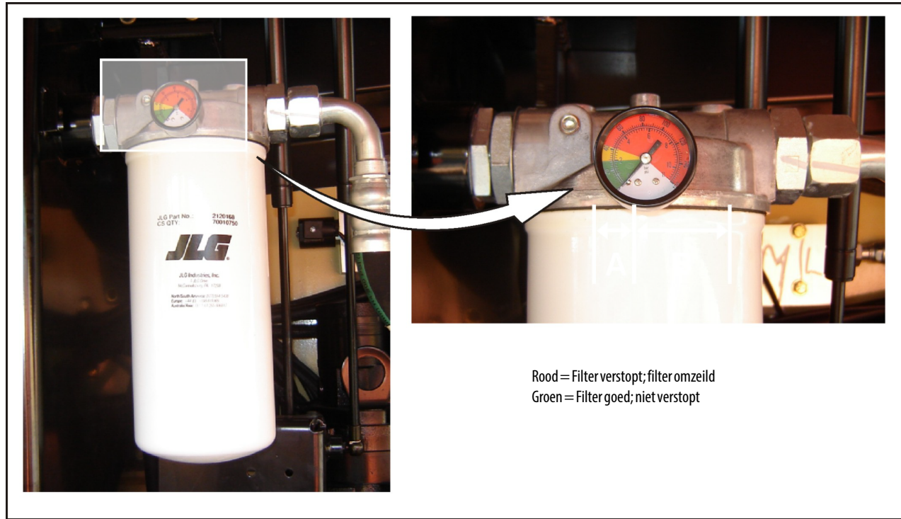
Figuur 7-9. Toestandindicator hydrauliekoliefilter – S/N 139396 tot heden
