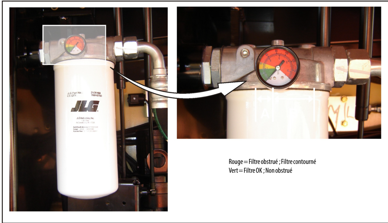
Figure 7-9. Témoin d'état du filtre de retour hydraulique – N/S 139396 à aujourd'hui
