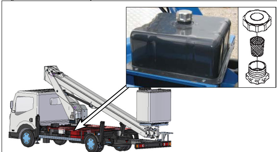
Fig. 35. Reservoir hydraulische olie
