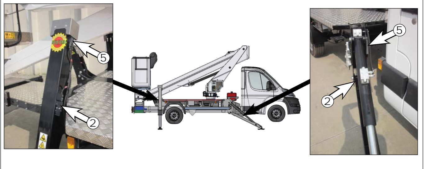
Fig. 9.3 Veiligheidsinrichtingen op de stabilisatoren A-A (vóór en achter schuin)
