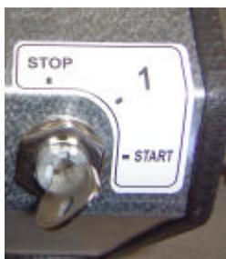
Exactement comme pour une voiture, le moteur de la balayeuse démarre par une rotation vers la droite de la clé de contact. Le réglage de l'accélérateur est effectué comme sur une machine avec démarreur manuel (cf. chapitre 4). Une fois le moteur démarré, relâcher la clé de contact. Elle reste sur la position « 1 » indiquée sur l'étiquette.
