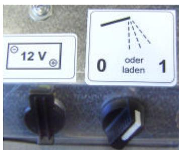
Après chaque utilisation de la balayeuse, rebrancher le chargeur au raccord de charge du pack d'accumulateurs. Afin que le courant de charge puisse circuler, le bouton rotatif au milieu du pack d'accumulateurs doit être en position « 1 ». (Si un système de vaporisation d'eau est monté, la pompe à eau est également activée et désactivée à l'aide de cet interrupteur)
